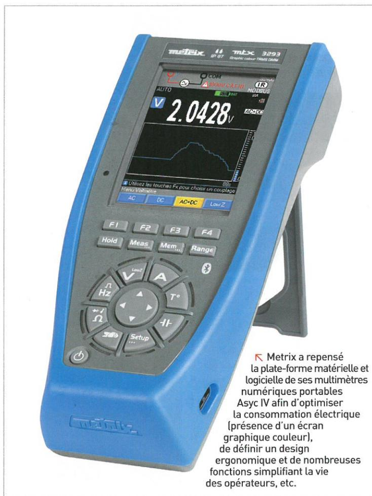
Metrix a repensé la plate-forme matérielle et logicielle de ses multimètres numériques portables Asyc IV afin d'optimiser la consommation électrique (présence d'un écran graphique couleur), de définir un design ergonomique et de nombreuses fonctions simplifiant la vie des opérateurs, etc.
