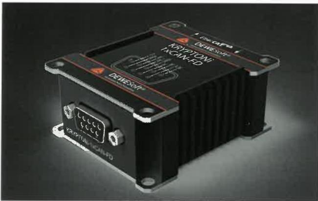
Les besoins en bande passante des nouvelles applications automobiles augmentent rapidement. Pour cela les équipementiers automobiles ont introduit le bus CAN FD dans les voitures récentes. Dernier module de la gamme Krypton One en version durcie de DEWESoft, le « KRYPTONi-1xCAN-FD » fonctionne dans des conditions extrêmes, allant de -40°C à +85°C avec un indice de protection IP67.
