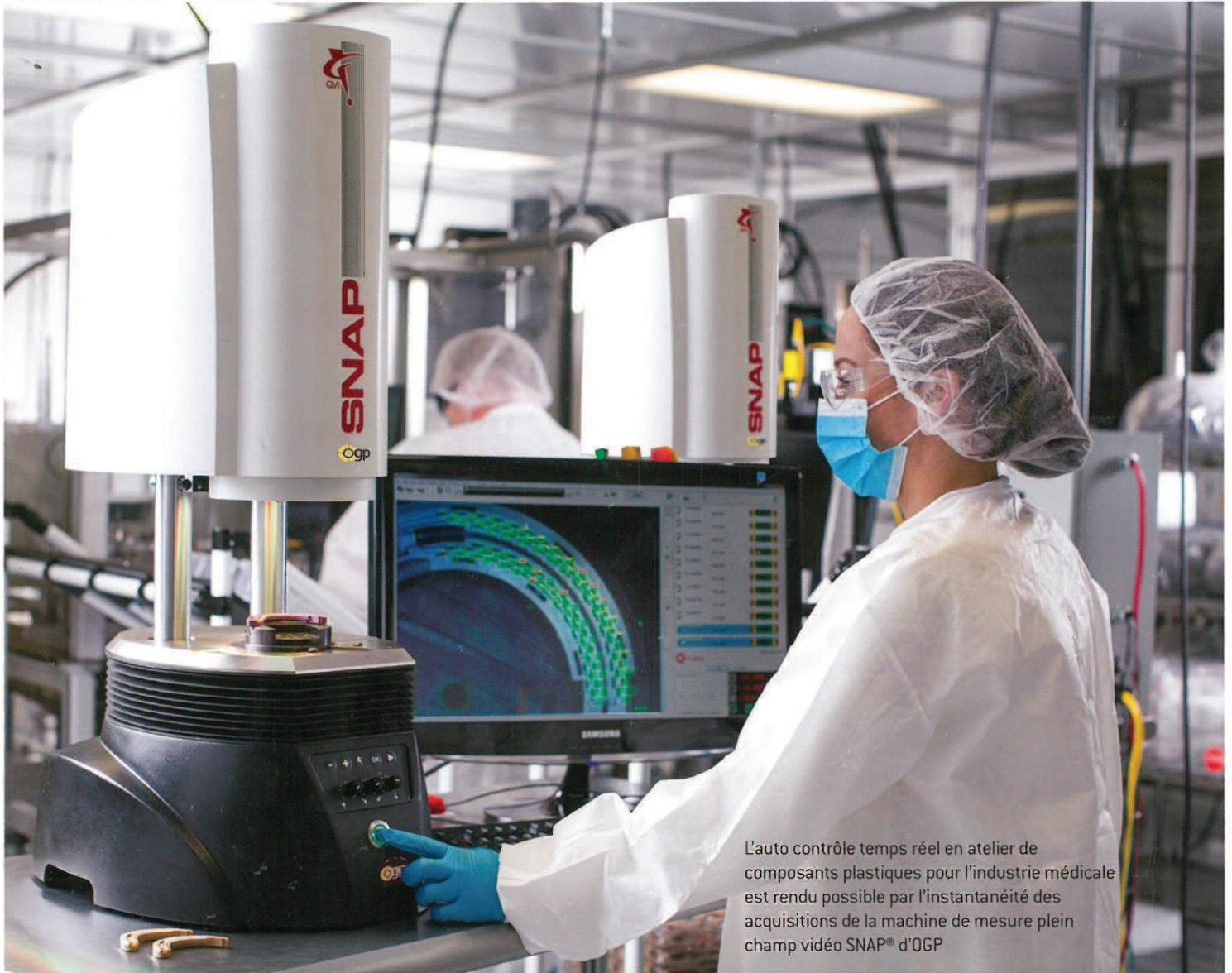
L'auto contrôle temps réel en atelier de composants plastiques pour l'industrie médicale est rendu possible par l'instantanéité des acquisitions de la machine de mesure plein champ vidéo SNAP® d'OGP
