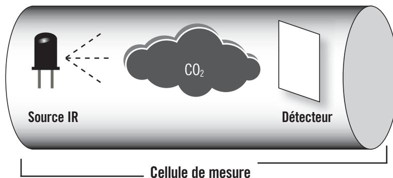
Le CO<sub>2</sub> et autres gaz absorbent de façon « spécifique » le rayonnement IR.
