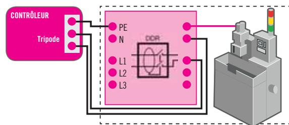
Le test de DDR permet de vérifier le fonctionnement des DDR.
