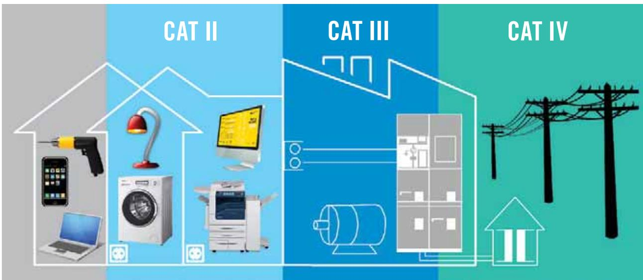
**CAT II : Mesures effectuées sur des circuits directement branchés à l'installation basse tension.**
