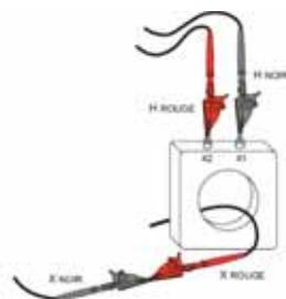
entre spire. De plus la mesure précise du courant d'excitation, permet d'identifier un problème dans le noyau magnétique du transformateur tel que type et épaisseur du matériau, contraintes mécaniques, variation d'entrefer et assemblage.
