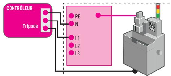
La mesure de l'impédance de boucle et le calcul du courant de défaut (PFC) permet de vérifier l'adéquation des calibres des organes de coupure automatique ou fusibles.
