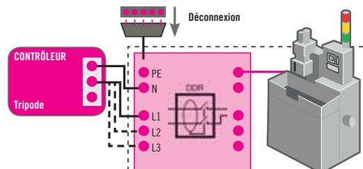
Lors de la déconnexion des machines, les condensateurs de valeur élevés peuvent fournir une tension dangereuse. Ce test mesure si le temps que met la tension de décharge à atteindre une valeur non dangereuse est conforme aux prescriptions (< 5s/< 1s).
