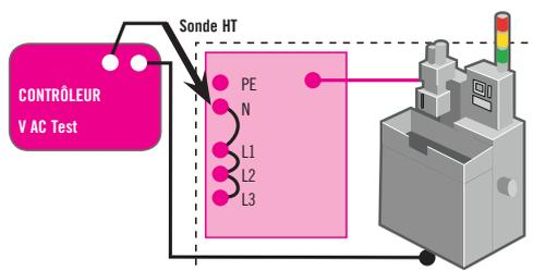
Le test diélectrique AC permet de confirmer l'aptitude du dispositif à fonctionner à sa tension de service. Ces tests se font à une tension supérieure à celle du fonctionnement normal.
