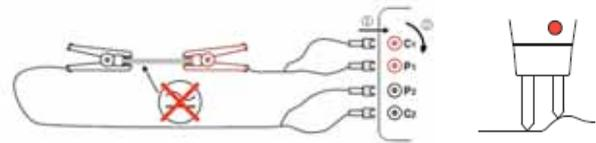
**Les micro-ohmmètres doivent avoir une résolution de 1  $\mu\Omega$  voire de 0,1  $\mu\Omega$ , une large étendue de mesure, ainsi qu'une compensation des effets thermocouple par inversion du courant de mesure.** Pour la sécurité de l'opérateur, il convient que l'équipement soit protégé contre les surtensions accidentelles, interdise la mesure en présence de tension perturbatrice et opère, après l'arrêt de la mesure, une décharge automatique dans le cas de mesure sur objets inductifs.
