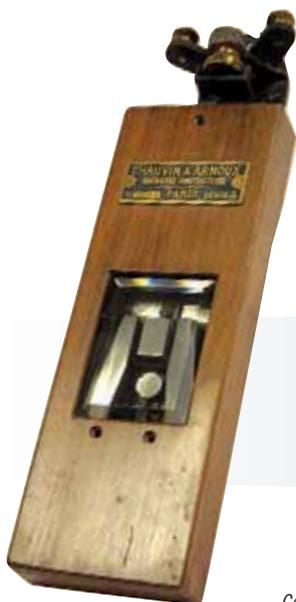
Galvanomètre à réflexion de 1895
