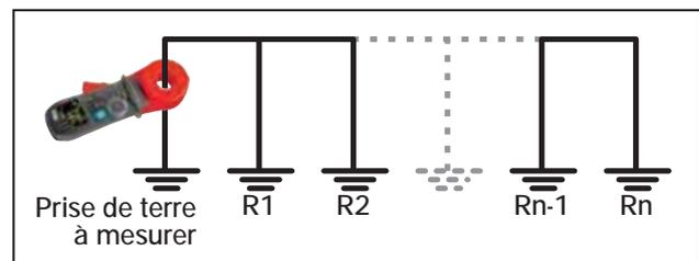
Schéma de principe Méthode à 2 pinces
