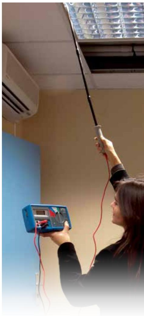
Contrôleur d'installation multifonction
