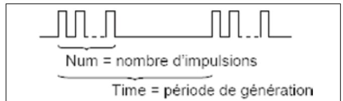
Elle superpose à la fonction courante une commande marche/arrêt de la composante alternative du signal MAIN OUT.
