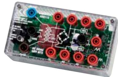
MTX 112U : sonde différentielle double intégrée
