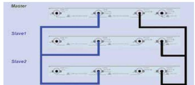
Elle permet de synchroniser plusieurs GX 320 montés « en cascade ». Le générateur utilisé comme « Maître » fournit aux autres appareils « Esclaves » l'horloge (Clk), ainsi qu'un signal de synchronisation (Ctrl). Cela permet à tous les générateurs de démarrer en même temps et de maîtriser leur déphasage.
