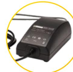
LO STRUMENTO VIENE ALIMENTATO DIRETTAMENTE DAGLI INGRESSI DI TENSIONE DELLA MISURA
