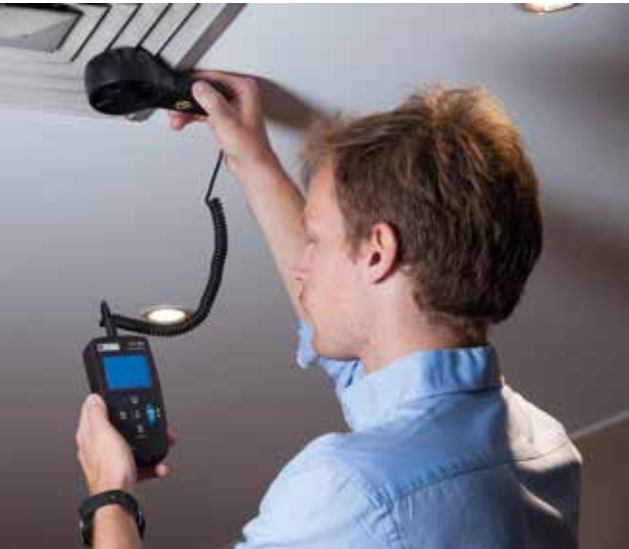
Messung des Luftdurchsatzes mit einem Thermo-Anemometer CA 1227
